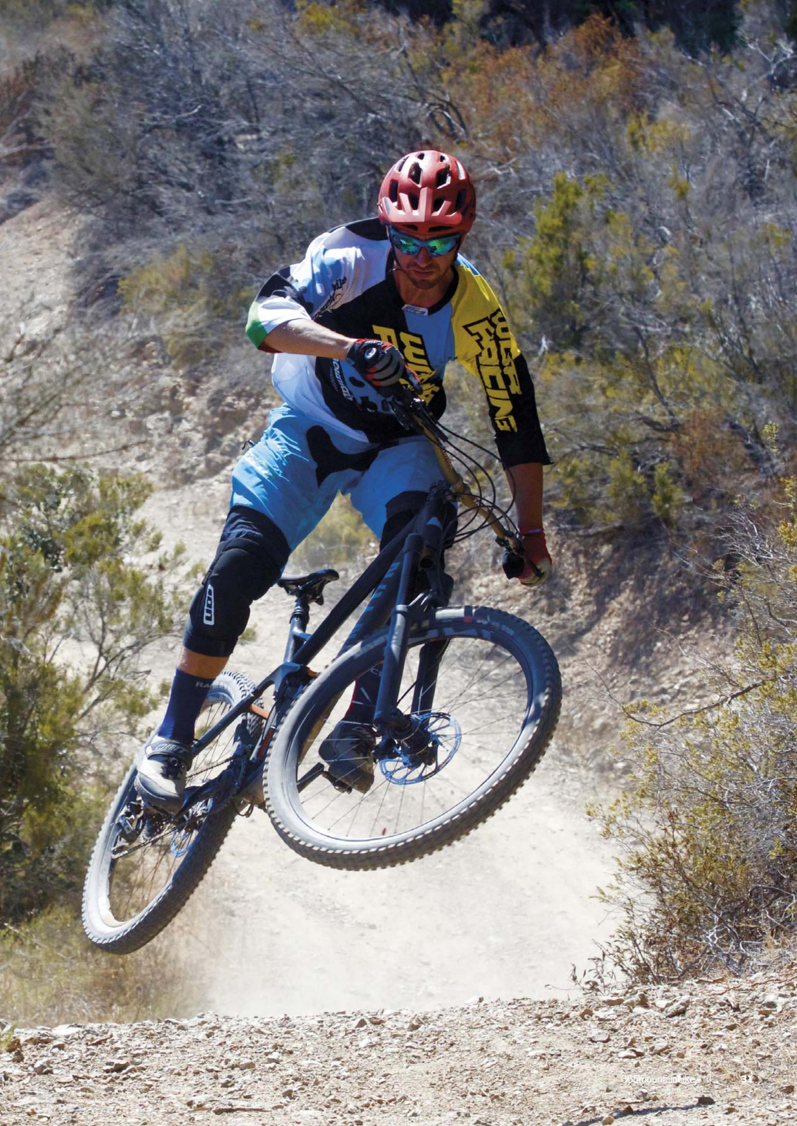
**L**a Strive mantiene le caratteristiche del progetto originario (presentato 3 anni fa) ma è stata aggiornata con nuova componentistica e uno Shapeshifter ora più affidabile. Ruote 27,5" (o 650b) con escursione di 160mm all'anteriore e 163mm al posteriore (modificabile in 130mm tramite lo Shapeshifter, che spiegheremo nel dettaglio in seguito). Pochi marchi, per ora, propongono un cambiamento dinamico dell'escursione, ma la direzione potrebbe essere proprio questa grazie alle nuove tecnologie.
